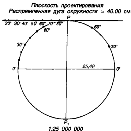
Рис. 6.19. Вспомогательный чертеж для построения картографической сетки в проекции Постеля (чертеж уменьшен)
